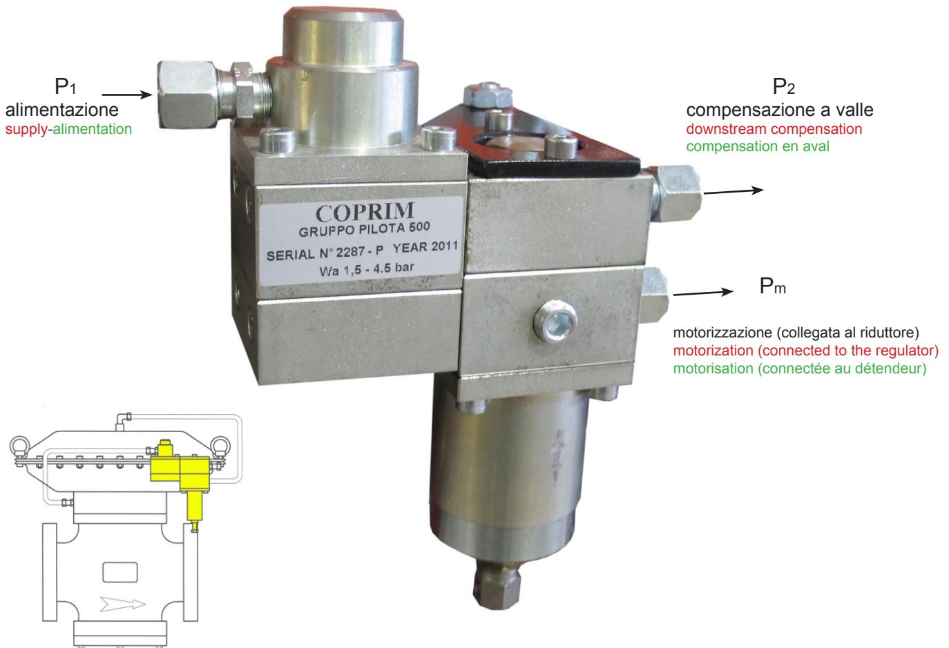
Il pilota può lavorare con tutti i tipi di regolatori in quanto non necessita di travasi interni al regolatore (membrane forate), avendo il pilota stesso un travaso interno.
