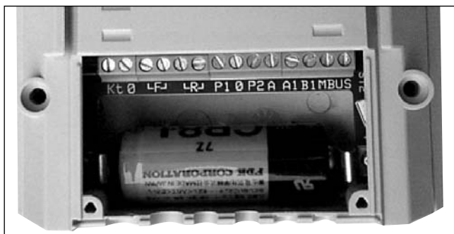
La figura mostra la morsettiera di collegamento e la batteria
